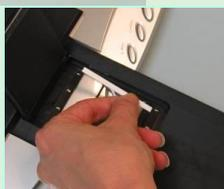
Remover a almofada de absorção, colocar no Leitor QuickScan
