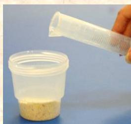
2. Adicionar 5 mL/g de Tampão de Extração (por exemplo: 100 mL para uma amostra de 20 gramas)
