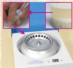
4. Transferir uma parte da amostra para um tubo e centrifugar por 3 minutos em 2000 x g (não RPM) (seguir instruções do fabricante da centrífuga)
