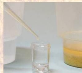
5. Pipetar 50 µl de solução tampão DB3 em um tubo de reação. Em seguida, com uma nova ponteira da pipeta, adicionar ao mesmo tubo 200 µl da amostra centrifugada
