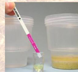
6. Homogeneizar muito bem a amostra utilizando a ponteira da pipeta. Em seguida, colocar a tira QuickTox no tubo. Aguardar 10 minutos para ler o resultado da tira
