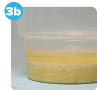
Alternativamente, permitir que a amostra descanse até que duas camadas se formem; a camada superior (amarelada) contendo os resíduos de aflatoxina será usada nos testes
