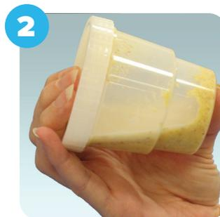
Tampar e agitar por 60 segundos em um agitador mecânico (ou manualmente por 2 minutos)
