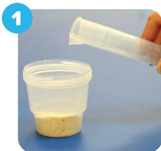
Adicionar a sub-amostra de 10-50 gramas no copo; depois adicionar quatro volumes de etanol 50% por grama de amostra (por exemplo, 25g de amostra + 100 mL de etanol 50%)
