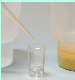
Adicionar Tampão DB2 no tubo, e em seguida, o extrato filtrado; misturar bem
